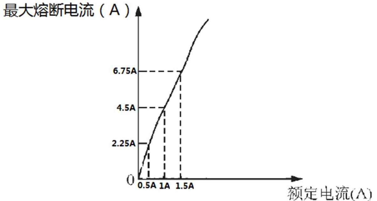
(图 2: 熔断电流与额定电流的对应关系)
