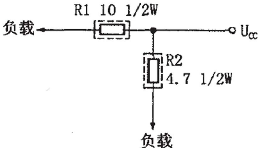
(图3: 熔断电阻器应用电路图)
