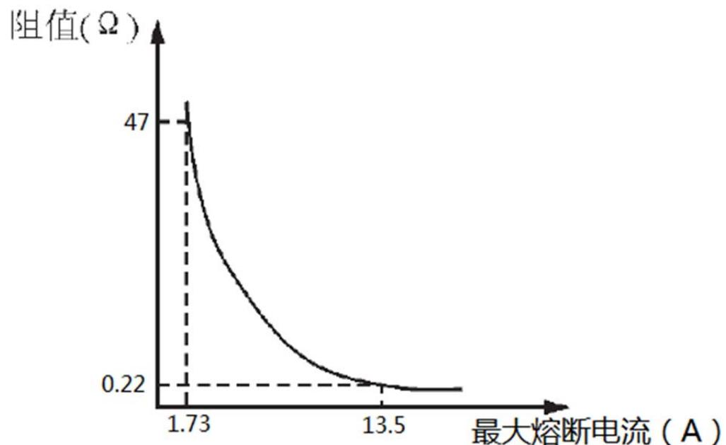
(图 1: 熔断电流与阻值的对应关系)
